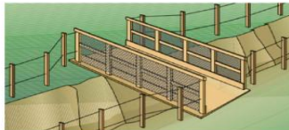
Figura 5 – Passarela em escavação para circulação de pessoas
