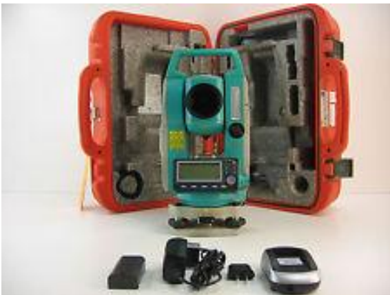
Foto 1- Modelo da estação total utilizada.
